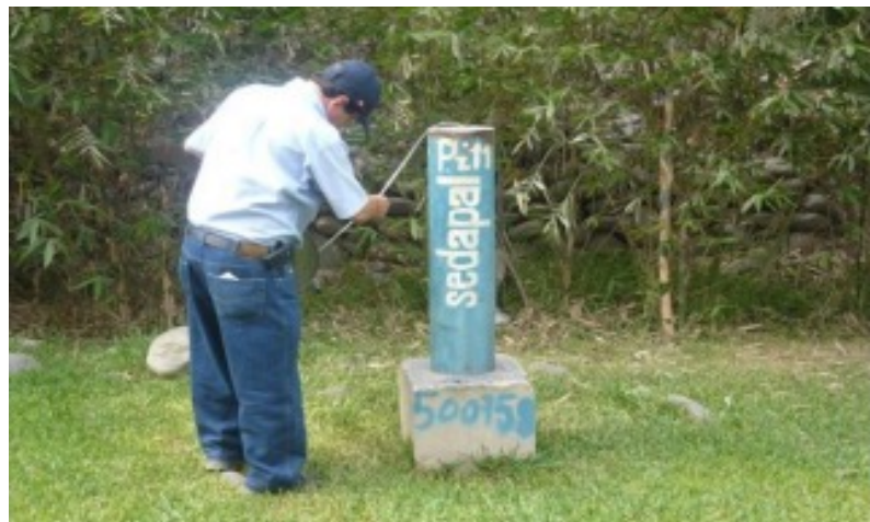
Monitoreo de la red de piezómetros del acuífero de Lima (foto: SEDAPAL S.A.).
