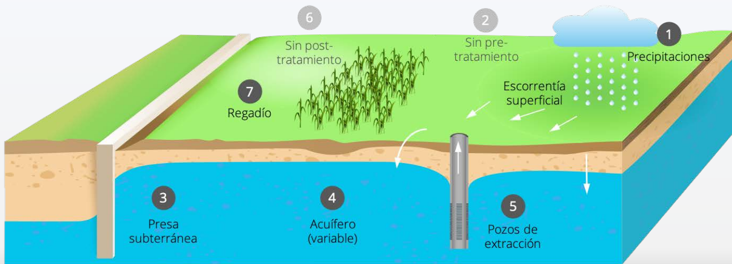
Diagrama de la recarga gestionada de acuífero
