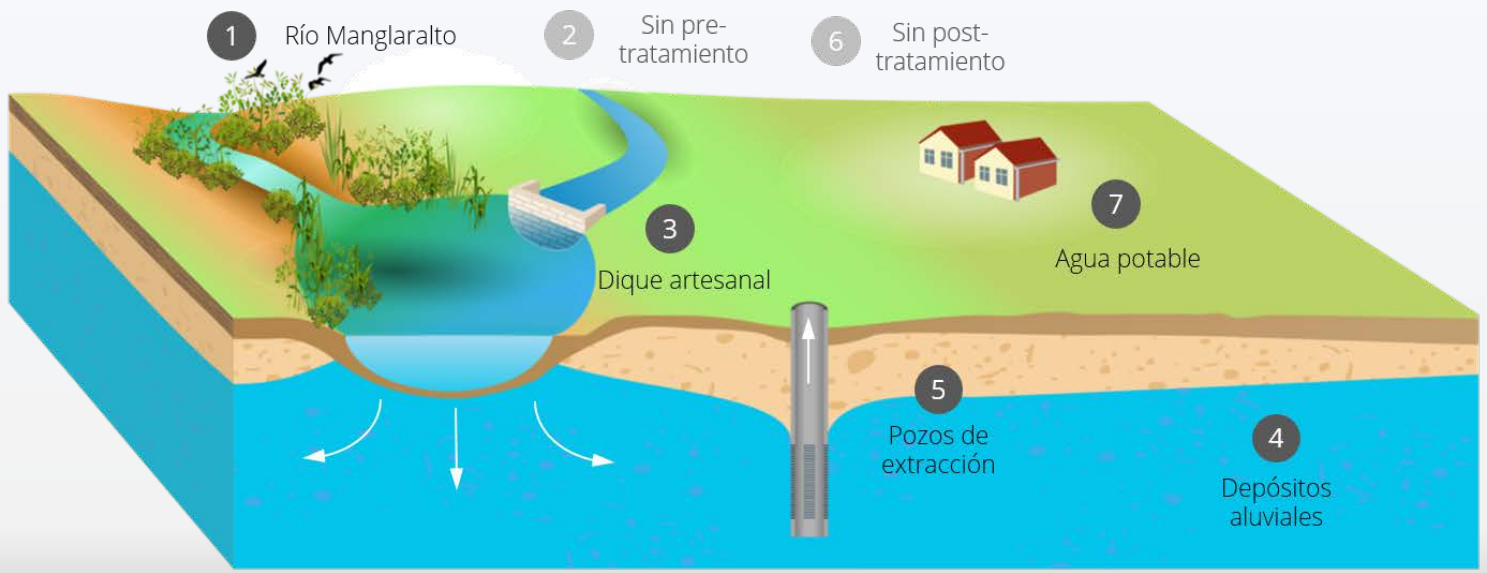
Diagrama de la recarga gestionada de acuífero
