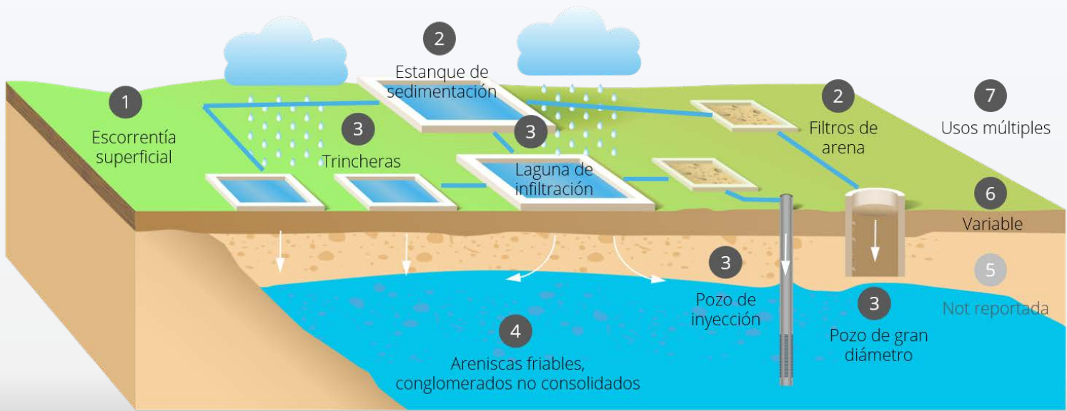
Diagrama de la recarga gestionada de acuífero
