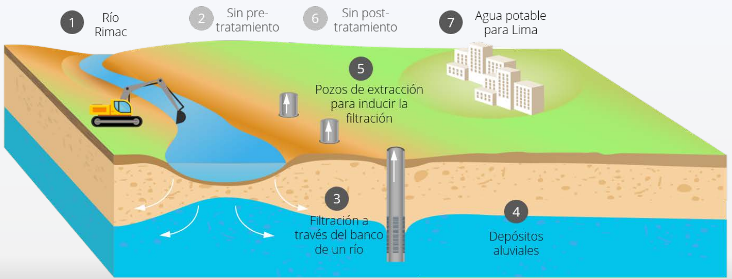
Diagrama de la recarga gestionada de acuífero
