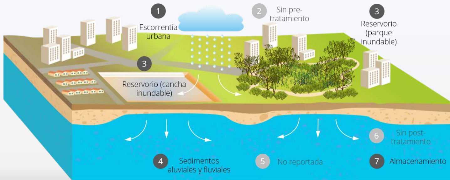
Diagrama de la recarga gestionada de acuífero
